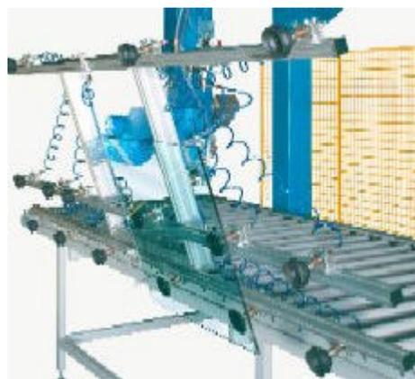
Il caricatore automatico a Controllo Numerico tipo CAL-NC è in grado di trasferire le lastre di vetro dal carrello verticale al trasportatore orizzontale.
